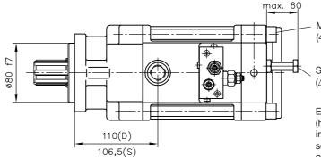
Max. torque 150 Nm (4 x tie rod M14 x190)
