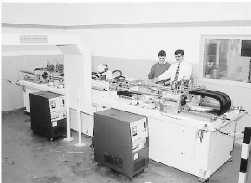
Im Prüffeld werden neuentwickelte Dichtungen getestet und modifiziert. Newly developed seals are evaluated and modified on a test rig.
